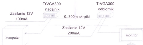
Rys. 1 Schemat połączeniowy nadajnika i odbiornika TrVGA300
